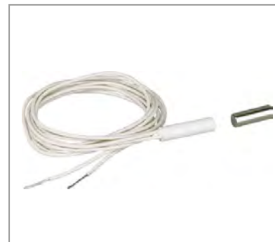
REEDKONTAKT Einfacher Reedkontakt oben in Stock und Türblattnal eingepohrt. Rückmeldung: Tür liegt im Falz!
