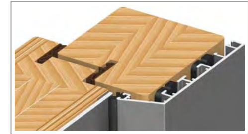
Detail - Alu-Schale Aussen & drei Dichtungsebenen
