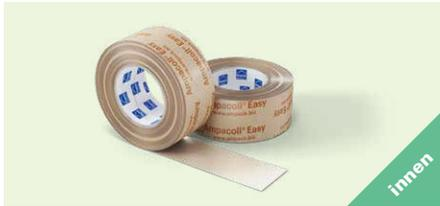
Acrylklebeband auf Papierbasis für die luftdichte Verklebung von Überlappungen bzw. Stößen bei Bahnen und plattenartigen Baustoffen, jeweils bei glatten Oberflächen im Innenausbau. Die Spezialbeschichtung ermöglicht die Verarbeitung direkt ab der Rolle, ohne Abziehpapier.
