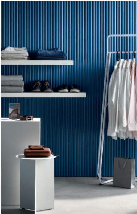
Die HTS Riffel- und Profiloberflächen sind nicht brandschutzgeprüft und nur für den trockenen Innenbereich geeignet.
