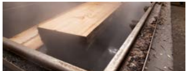
2. Kochen und Dämpfen des Stammes vor der Messerung in Chromstahlgruben.
