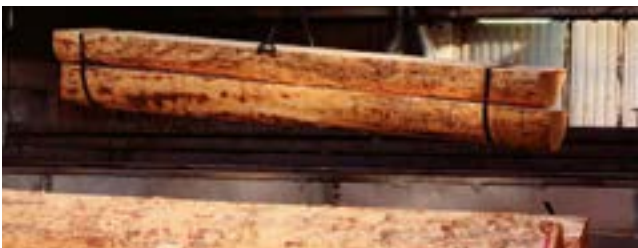
1. Eintreffen der Stämme im Furnierwerk. Auftrennen in der Länge und Zusammenbinden mit Stahlband.
