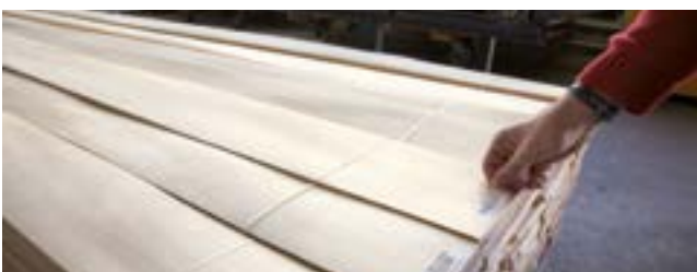
7. Elektronisches Vermessen der besäumten Furniere.
