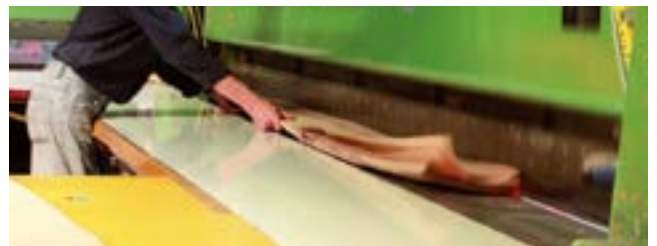
6. Paralleles Besäumen der Furniere auf der Frasierstrasse.
