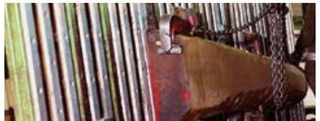
4. Einspannen des Stammteiles auf dem Flichtisch, welcher den Stamm gegen das Messer führt.
