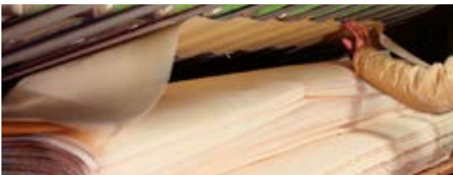
5. Sofortiges Trocknen im Presstrockner auf eine Restfeuchtigkeit von ca. 8 – 10 %.
