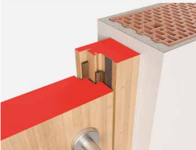
EI 60 Pfostenstock flächenbündig mit Aufdoppelung
